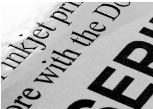
Druckbeispiele des K150 mit UV-aushärtender Tinte (oben) und Lösungsmittel-tinte (unten)
